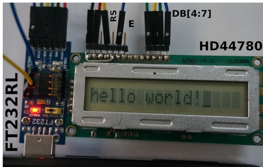
FIGURE 6 – Affichage d'un classique "hello world" sur un écran compatible HD44780 piloté par un FT232 en mode bitbang
